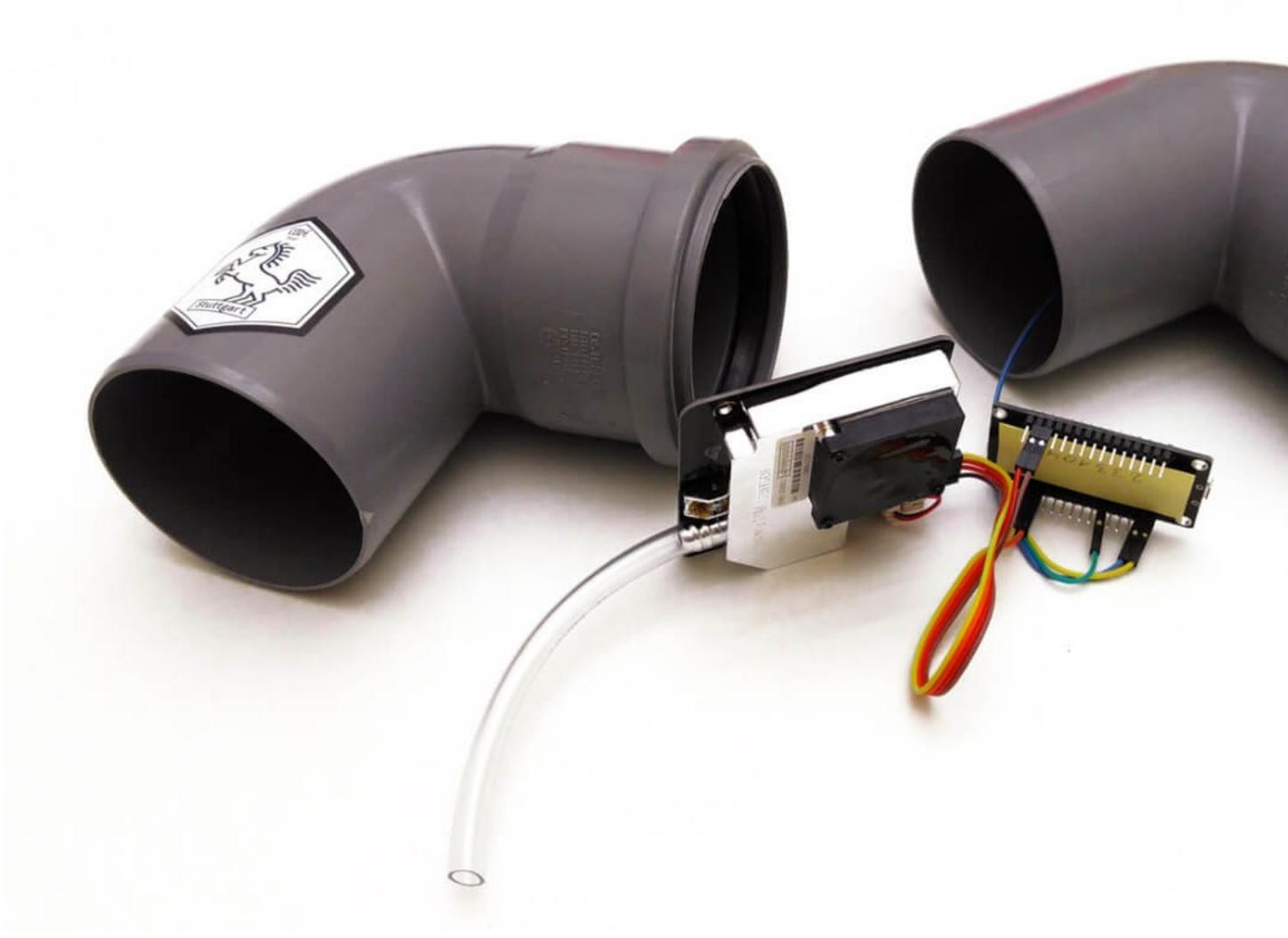
Mit zwei HT-Rohren aus dem Baumarkt und einem Mikrocontroller bauen wir einen Feinstaubsensor. Dieser kann zum Beispiel auf dem Balkon angebracht werden und misst alle 2,5 Minuten, wieviel Partikel der Größe  $2,5 \mu\text{m}$  in der Luft sind. Die Daten werden über das Internet ausgewertet.
